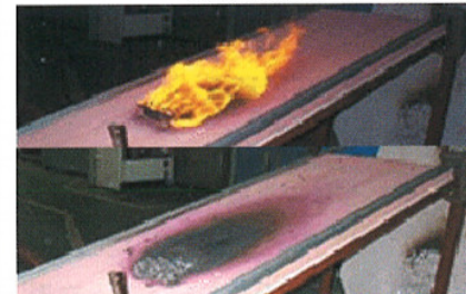
②不燃性、低発煙性：飛び火想定試験例 下-試験後の炭化状態
